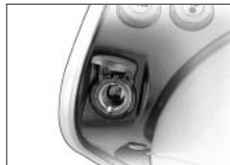
Toma de corriente delantera izquierda
